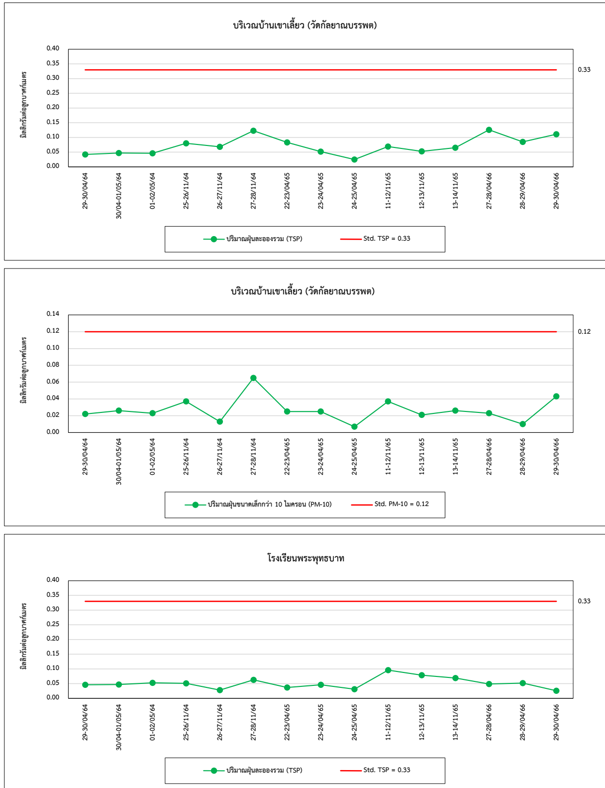
รูปที่ 4.1-1 กราฟเปรียบเทียบผลการตรวจวัดคุณภาพอากาศในบรรยากาศ ระหว่างปี 2564-2566 (ต่อ)
